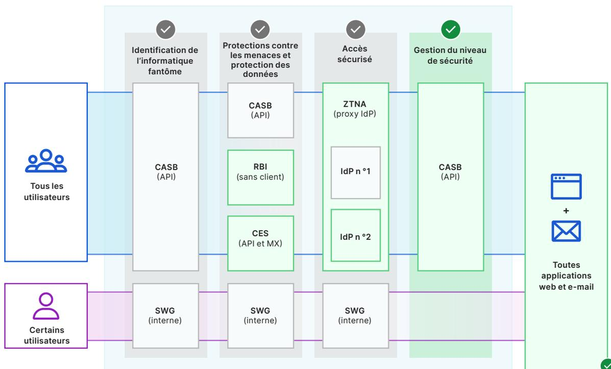
SWG = passerelle web sécurisée | CASB = Cloud Access Security Broker | IdP = fournisseur d'identité |
